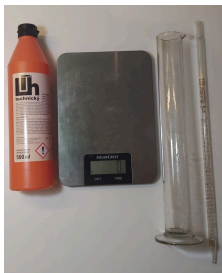
Obr. 36: Pomůcky – zleva technický líh, kuchyňská váha s přesností na 1 g, odměrný válec s objemem 200 ml a rozlišením 2 ml a pipeta pro 10 ml s rozlišením 1 ml.
