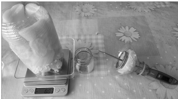
Obr. 39: Fotografie rozloženého kalorimetru. Vlevo – tepelná izolace stojící na váze, uprostřed – nádobka kalorimetru, vpravo – izolované víko s kuchyňským teploměrem.
