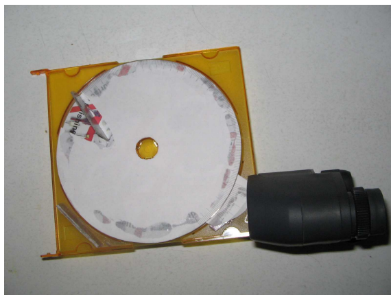
Obr. 10. Konstrukce sextantu ze dvou CD
